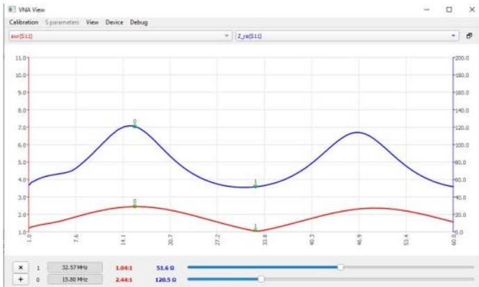
Se utilizziamo il NanoVNA in modalità standalone, sempre con uno sweep da 1 a 60 Mhz e con visualizzazione di SWR, R e X, relative al CHO, vediamo che la parte resistiva dell'impedenza è 118 Ω, direttamente dallo schermo del NanoVNA.
