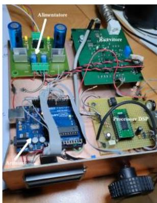
Ricontrollo la scheda mille fori sul quale è montato il circuito di demodulazione con il chip DSP FV-1 e non noto nessun problema.
