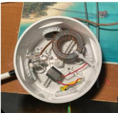
*L'induttanza per rendere risonante la mia verticale di 7 metri in 160 mt fatta con Toroide FT140-63 e un balun 1:1 su ferrite binoculare*
