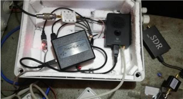
Arriviamo alla sostituzione del miniSDR con il RSP1A. Da questo punto di vista c'è stato un mezzo insuccesso su cui stiamo ancora facendo una serie di valutazioni. Per prima cosa abbiamo notato che, forse a causa della nuova antenna o forse della diversa sensibilità del ricevitore, la banda in 430 è praticamente saturata dalla sonda-beacon, cosa che non avevamo riscontrato precedentemente.
