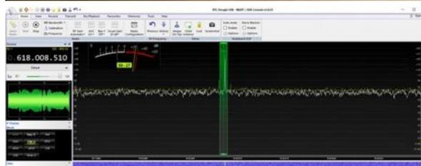
La seconda prova consiste nel ricevere la telemetria di QO 100 con LNB e HackRF one. Il segnale è basso, ma è comunque sufficiente per dare soddisfazione.
