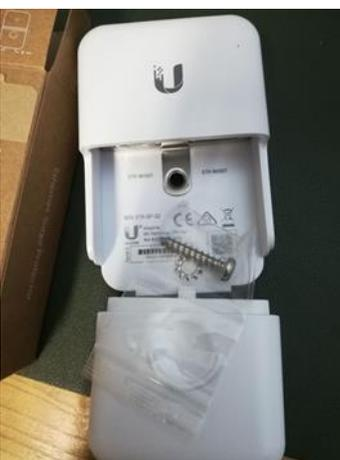
Avevamo qualche dubbio sul rispetto dello standard utilizzati per trasportare l'alimentazione, ma alla fine i documenti e i test hanno confermato che nel nostro caso i pin 4 e 5 portano il positivo e i pin 7 e 8 il negativo.
