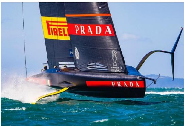
Quando la forza del vento è sufficiente, il foil sopravento che non ha più funzione di sostentamento, ma solo di bilanciatura, viene alzato dall'acqua diminuendo ulteriormente l'attrito.
